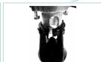
Agganciare il cono in posizione sull'uscita dell'ugello
